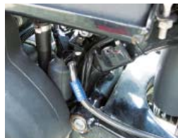
スイッチマウントアダプター ブレーキライン途中にスイッチを設置する際に、専用ホース*1とともに使用。右画像は使用例です。(XL883R O2モデル)
