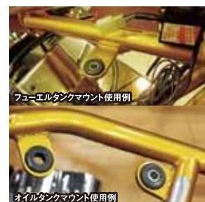
任意の長さへカットし、フレームへ溶接することで オイルタンクマウントステーなどに使用することも可能。
