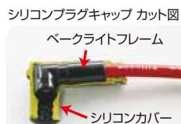
ベークライトフレームをシリコンでカバーした構造のため、プラグコードをネジ込みにて装着可能。
