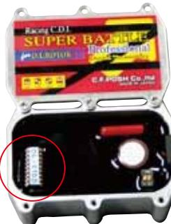
5種類(DLMA-1/DLMA-2/DLMA-3/DLMA-4/DLMA-5)のプログラム済みCPUからチョイスして頂けます。1CPUに4種類の点火時期がプログラムされております。リミッター回転数の指定は1CPUにつき1種類又はリミッター解除指定できます。
