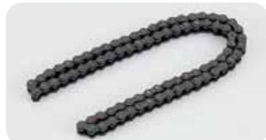
①継ぎ目ない滑らかな表面と優れた真円度を有する剛性の高いソリッドブッシュの採用により巻バッシュ採用の標準型ローラーチェーンに比べ、磨耗寿命が1.8~4倍という性能を実現。
