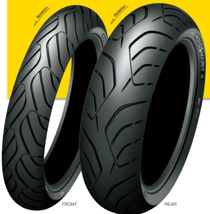
**COMPOUND / コンパウンド** ●リアに定評ある3分割マルチプルトレッド構造を採用。センターエリアに耐摩耗高分子量ポリマーをベースに微粒子シリカとウエットグリップ向上剤を配合した最新コンパウンドを配置し、ライフを大幅に向上させるとともに高いウエットグリップレベルをキープ。ショルダーエリアには微粒子シリカを配合した最新コンパウンドを採用しハイレベルのドライ&ウエットグリップを実現。あらゆるコンディションでの安定したグリップ性能とロングライフそしてスポーツ性能を発揮します。
