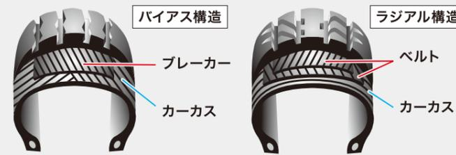
現在は大きく分けてバイアスとラジアルの2タイプが製造されています。バイアスタイヤは、カーカスのコードを中心線に対し30~40度の角度(バイアス)で交互に貼り合わせています。このコード角によってタイヤの形・剛性が決まります。ラジアル構造に比べて、設計自由度は小さいですが、路面のギャップをタイヤ全体で吸収しますから、ラジアルよりも乗り心地が良いのが特長でアメリカンやスクーター等、快適性を求められるバイクに装着されています。ラジアルタイヤは高速耐久性に優れた構造で、ほとんどのオンロードスポーツバイクに装着されています。カーカスのコードは放射線状(ラジアル)に並んでおり、ベルトによって締めつけられています。剛性はベルトだけで決定できますので、トレッドとサイドウォールの剛性を別々にコントロールすることが可能です。そのため、バイアスよりも柔らかいグリップ力のあるゴムを採用できるなど、設計の自由度が高い構造です。
