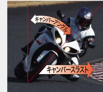
4輪車に対して2輪車の場合、バイクを傾けることによって発生する、キャンバースラストとコーナリングフォースで、旋回しています。キャンバーアングル(傾ける角度)が大きくなれば旋回力も増しますが、タイヤのショルダー部にかかる負担も大きなものになります。またタイヤの空気圧によっても接地形状が異なり、旋回性能に影響を与えています。このようなコーナリング特性の違いや、求められる役割によってタイヤ形状が違ってきます。トレッド面は4輪のように平面的ではなくサイドに回り込む形状となり、ショルダー部分の強度などにも2輪車独特の性能が求められています。
