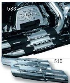
**SLOTTED POWER CELL HEAT SHIELD**
