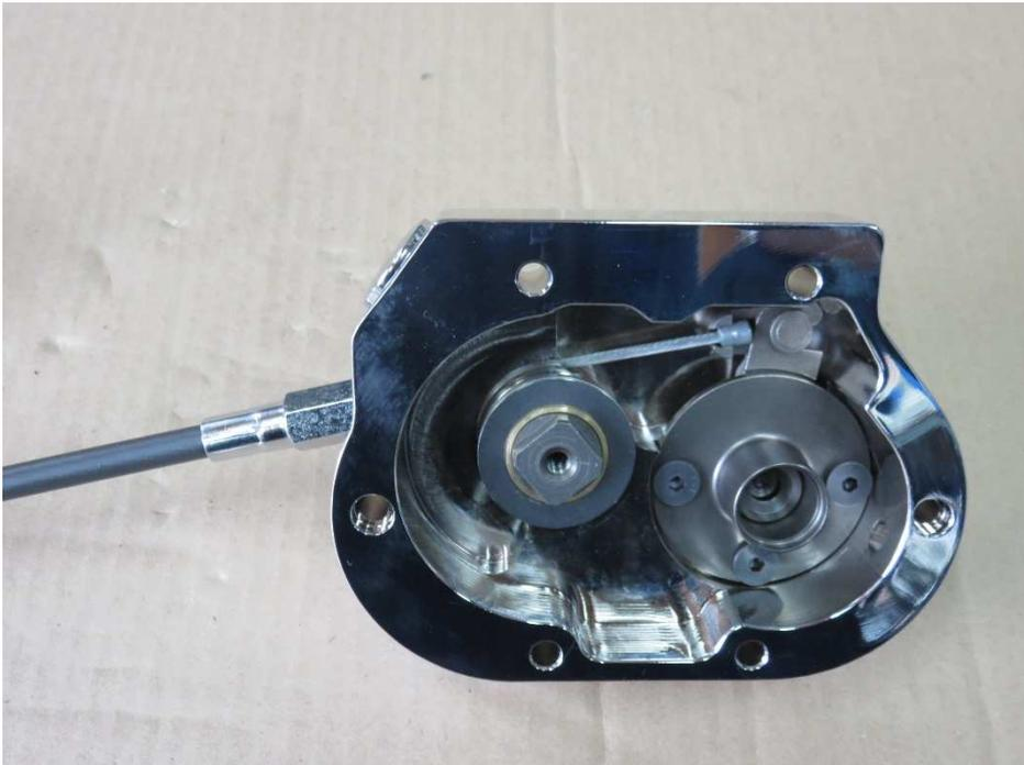
キッカーシャフト(構成部品③)の裏側にスラストベアリング(構成部品⑨)を取り付ける。
