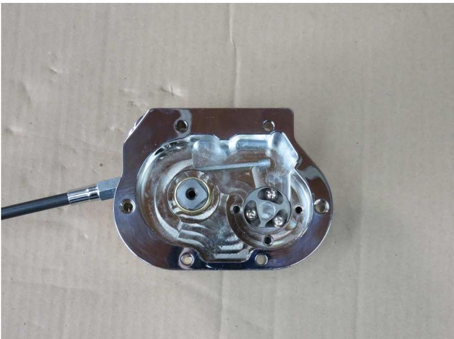
クラッチランプインナーとボールベアリング(構成部品⑤)をカバーにセットする。
