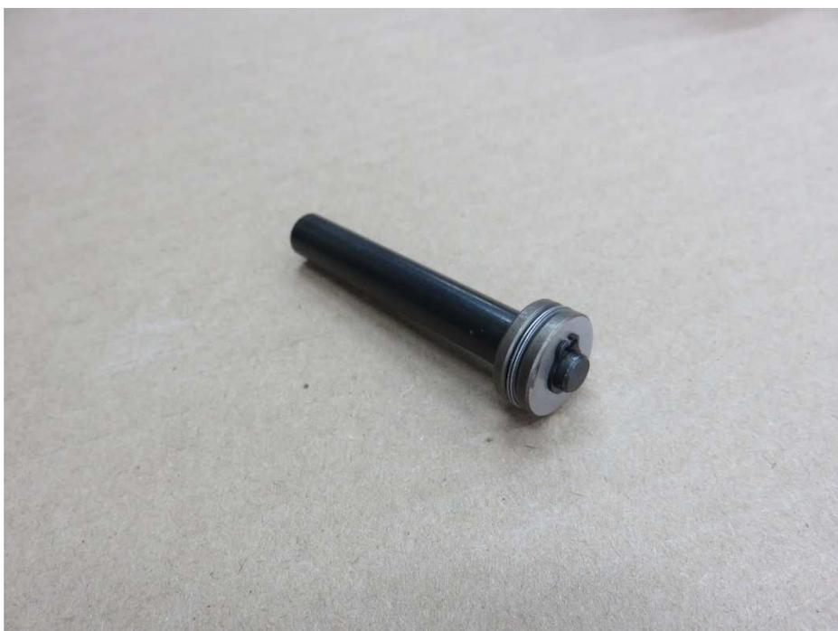
専用クラッチプッシュロッド(構成部品②)にスラストベアリング、スナップリングを組み付け、純正のプッシュロッドと入れ替える。
