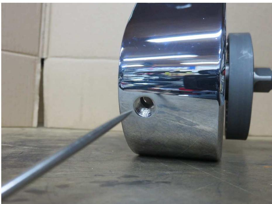
キッカーカバー後方に付いているプラグボルトを外した状態でトランスミッションオイルを注入口から注入する。
