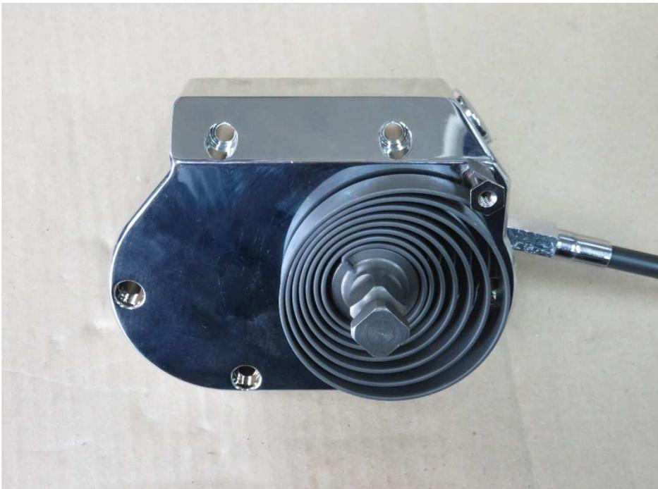
リターンスプリング(構成部品⑬)のエンドをキッカーシャフト(構成部品③)のスロット(切り欠き)部分に差し込み、もう片方のエンドをスプリングストッパー(構成部品④)に引っ掛ける。
