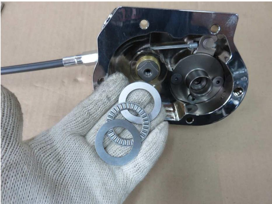
スラストベアリング(構成部品⑨)の取り付け準備をする。
