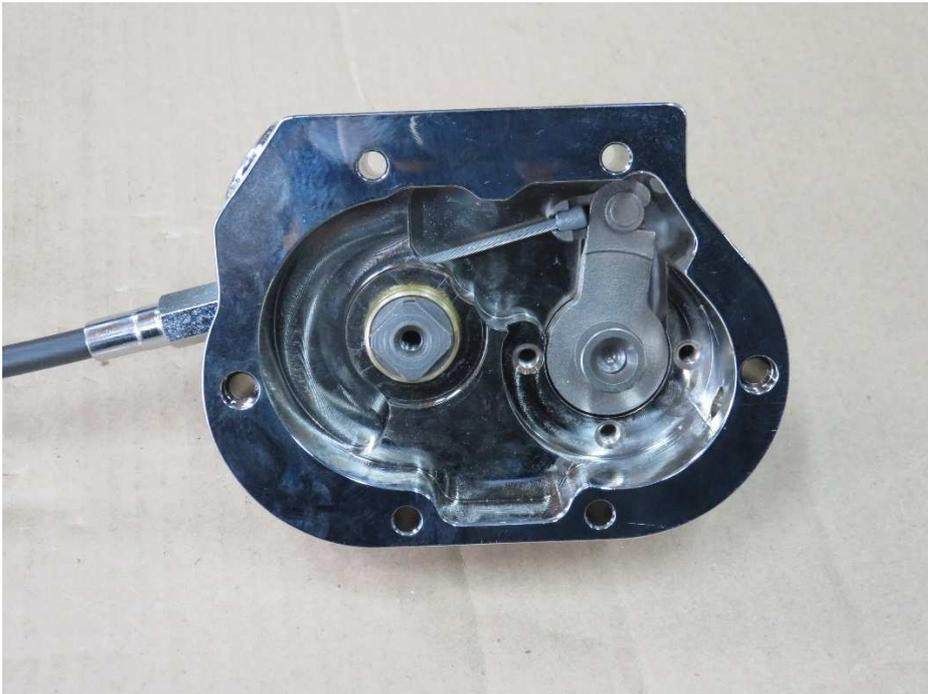
クラッチランプケーブルホルダー(構成部品⑥)にクラッチケーブルを組み付け、クラッチランプアウター(構成部品⑥)をセットする。
