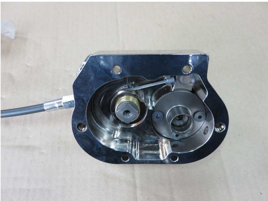
クラッチランプカバー(構成部品⑦)を組み付ける。ネジ(構成部品⑧)はロックタイト(青色)を塗る。
